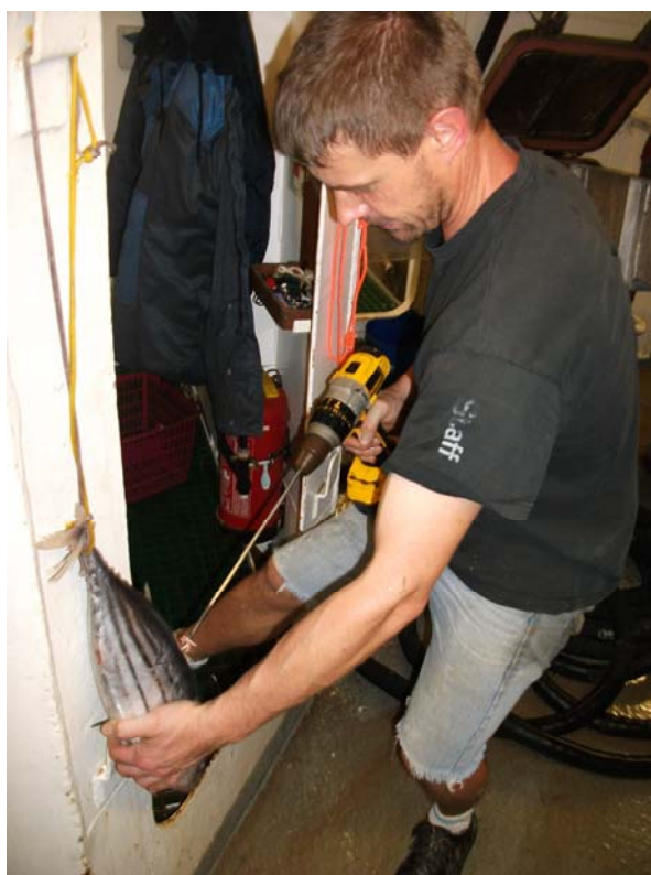
Photo 2 : Pour pouvoir être placé à -40^{\circ}\text{C} , les poissons en saumure sont testés et doivent être à -8^{\circ}\text{C} à cœur.
